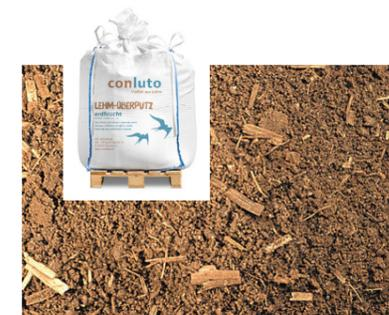
Lehm-Oberputz (erdfeucht) ist eine maschinengängige Fertigmischung nach DIN 18947. Er wird hergestellt aus: gemahlenem Baulehm, gemischt-körnigem Sand 0-2 mm und Stroh.
