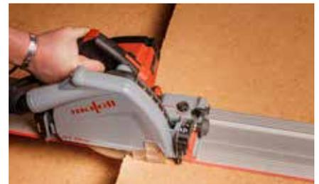
Zuschnitt mit Tauchsäge und Führungsschiene
