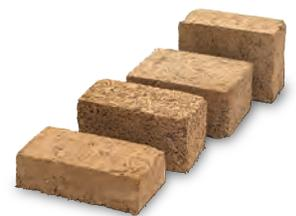
Leichtlehmsteine werden in einem der traditionellen Handformung nachempfundenen Verfahren hergestellt. Leichtlehmsteine NF 1200 sind für die Ausmauerung von Fachwerk besonders geeignet. Alle Leichtlehmsteine können im Innenbereich für nicht tragendes Mauerwerk und Vorsatzschalen verwendet werden. Die unterschiedlichen Raumgewichte entstehen durch die Beigabe von organischen Zuschlägen.
